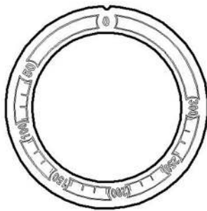
Рис.5: Термостат ТЭНов духовки
