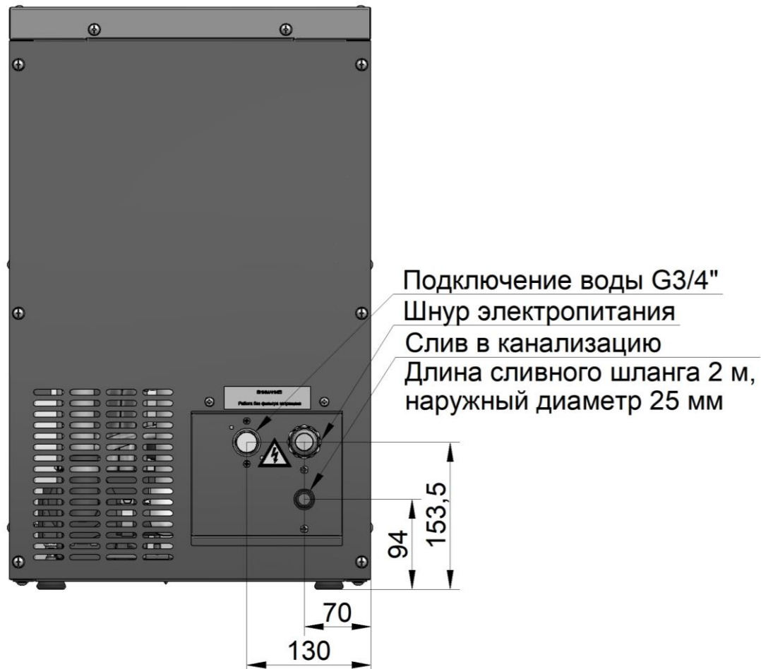
Рис. 5 Схема подключения льдогенератора
