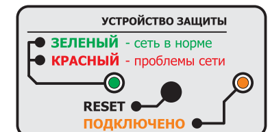
Устройство защиты плит на 220В
