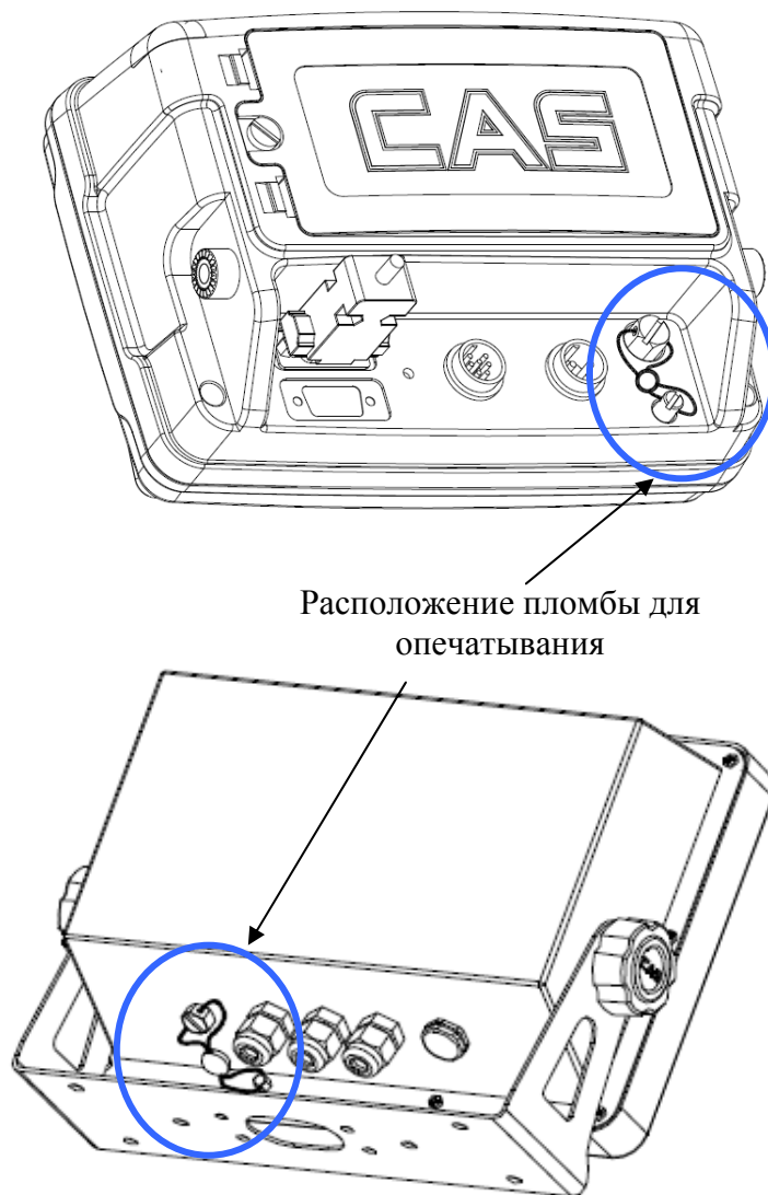
Рисунок 14.1 – Расположение поверочной пломбы индикатора
