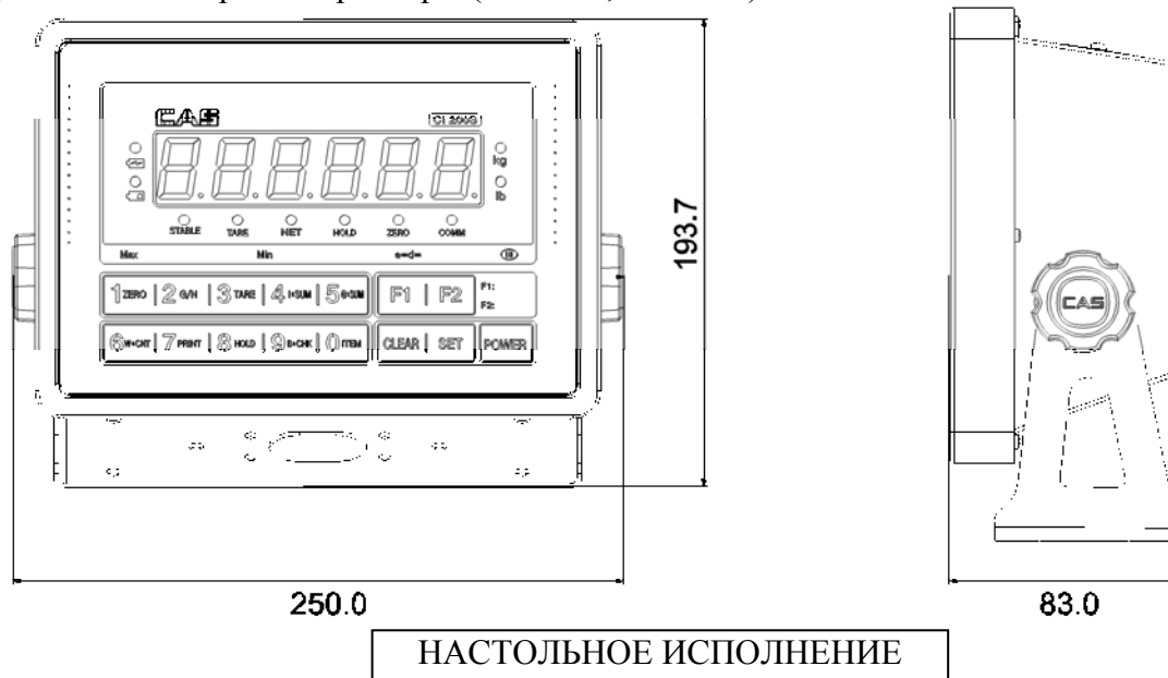
Рисунок 4.1 – Габаритные размеры (CI-200A, CI-201A)
