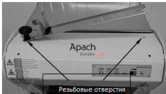
Рисунок 5 – Места завинчивания рым-болтов М8 для подъемных тросов
