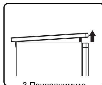
3. Приподнимите верхнюю крышку спереди и установите упор.
