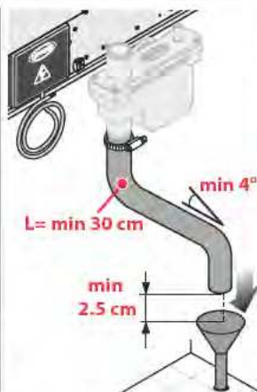
Выход сливного отверстия, расположенного в стене, должен иметь воздушный зазор не менее 25 мм.
